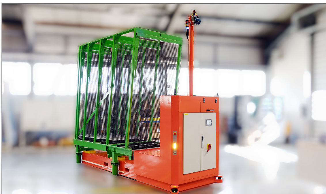
Eigenständig, selbstfahrend und taktgerecht übernehmen Automated Guided Vehicles von HEGLA beispielsweise den Transport von Fächerwagen zwischen dem Zuschnitt und den einzelnen Bearbeitungsstationen.
