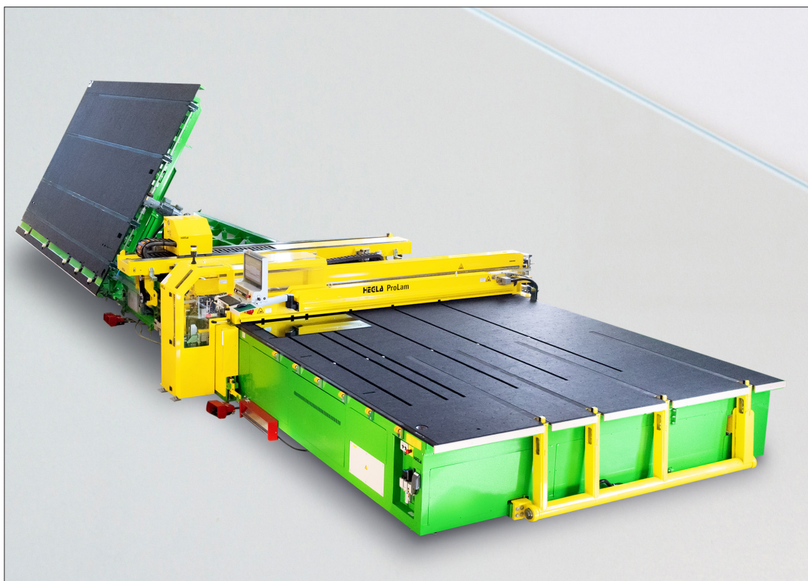
Erstklassige Schnittqualität, hohe Produktivität und Automation zeichnen die HEGLA ProLam als leistungsstarke Schneidanlage für Verbundsicherheitsglas aus.
