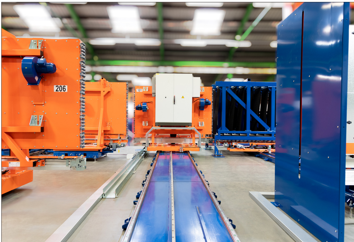
Die Sortieranlagen „SortJet“ erzeugen einen kontinuierlichen Glasfluss vom Zuschchnitt zu nachfolgenden Bearbeitungsstationen. Das Glas wird dabei in die richtige Reihenfolge sortiert und zusätzliches Potential zur Verschnitt- und Ablaufoptimierung geschaffen.
