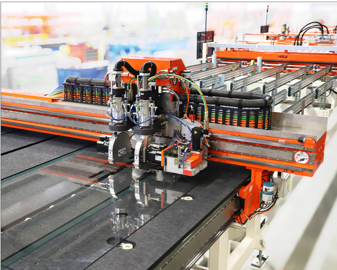
Die vollautomatische HECLA-Schneidanlage „Galactic“ erfüllt mit Ihren wartungsarmen, elektromagnetischen Linearantrieben professionelle Ansprüche an den Floatglas-Zuschnitt.
